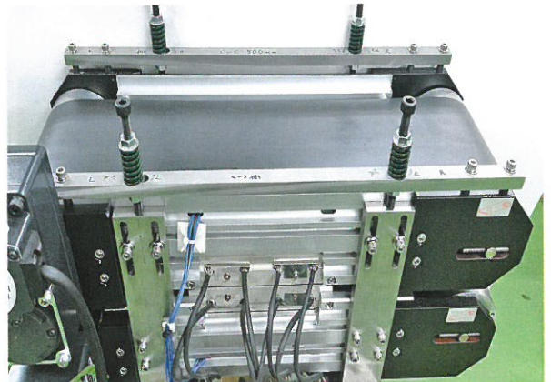
ダブルベルトプレス加熱冷却搬送システム
